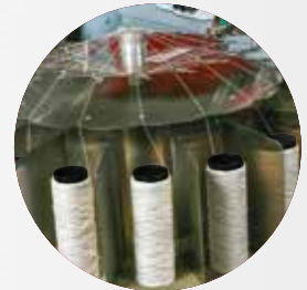
Değışken Sayılı D ner Magazin Rotary Magazine With Variable Number
